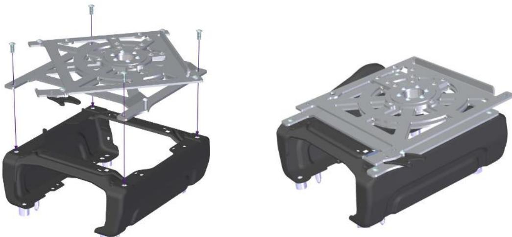
Upevněte otočný držák pomocí 4 šroubů s válcovou hlavou DIN 7380 - M 10x25 (jsou součástí dodávky) – na závit naneste pojíšťovač závitů (lepidlo)
