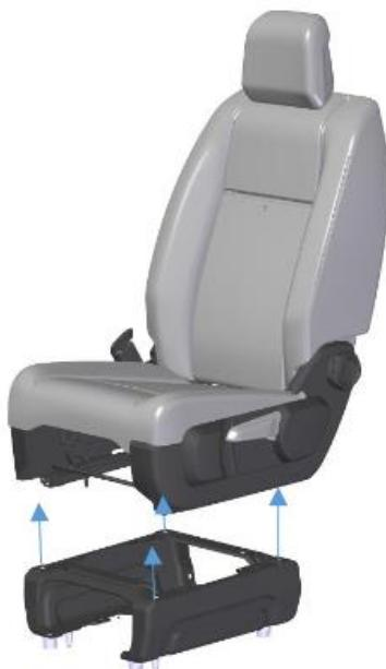
Chcete-li sedadlo vyjmout, odpojte elektrickou přípojku pod sedadlem (žlutý konektor)
